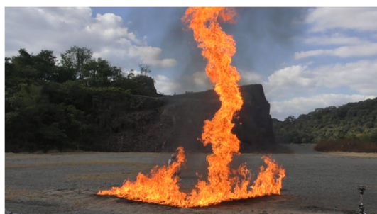
図：野外実験で再現された火災旋風の様子
